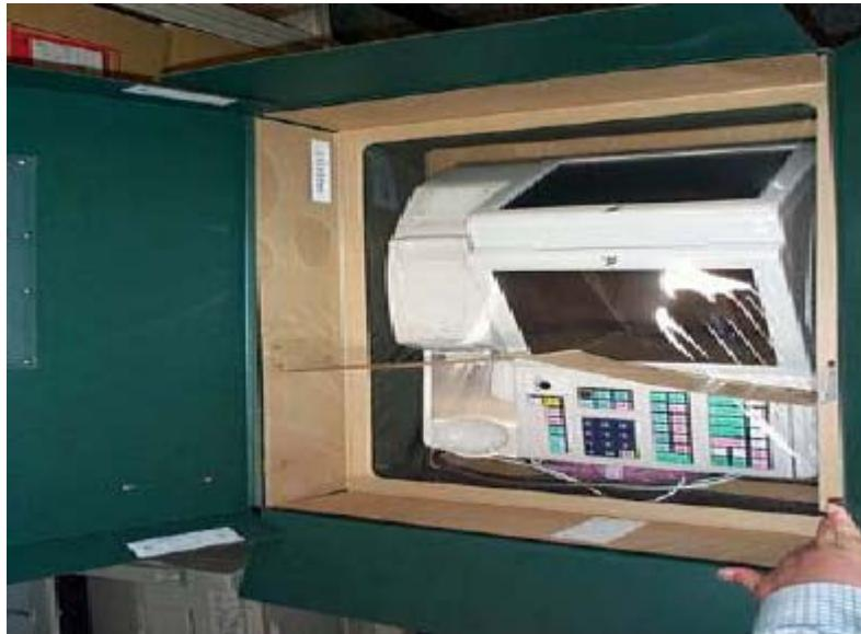
上下のフィルムでPOSレジスターを挟み、宙吊り状態で固定
